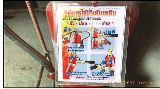
รูปที่ 54 วิธีการใช้ถังดับเพลิง
